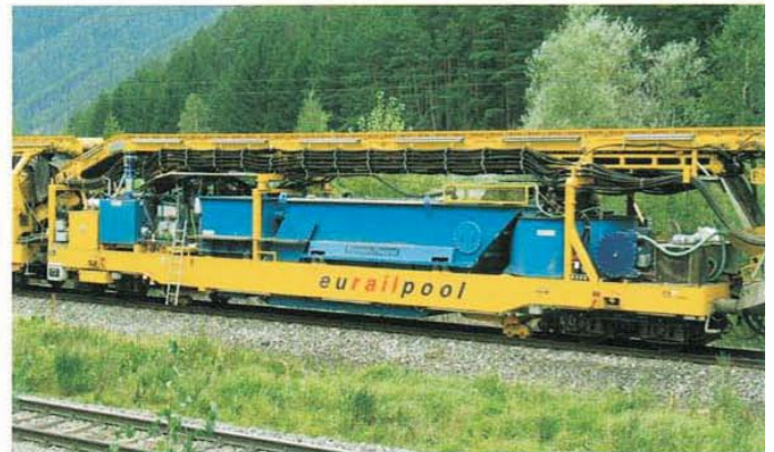
Kläranlage zur Wiederaufbereitung des Washwassers
