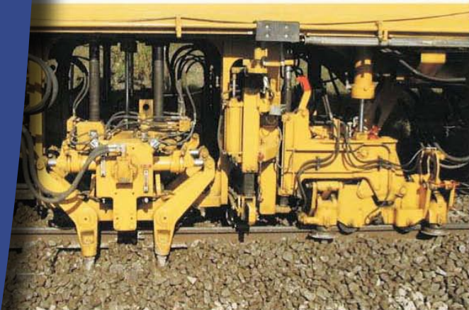
Stopfmaschineneinheit zum Nivellieren, Heben, Richten und Stopfen des Gleises
