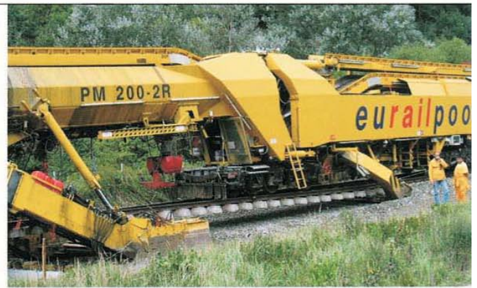
PM 200-2 R – Unterbausanierungsmaschine der neuesten Generation
