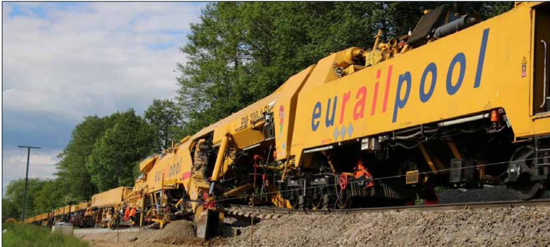
Die PM 200-1 BR/C ist eine Planumsverbesserungsmaschine in Modulbauweise. Mit ihr kann wahlweise vollständige Bettungserneuerung, Bettungsreinigung oder Herstellung von KG 2 aus vorhandenem Altschotter in Kombination mit gleisgebundener Planumsverbesserung durchgeführt werden. Die Maschine kann in Sperrpausen ab 7 Std. eingesetzt werden.
