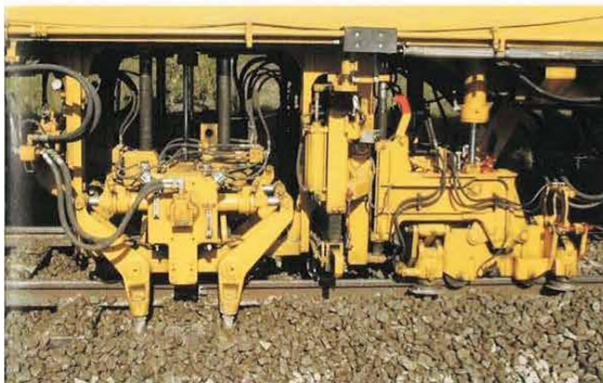
Stopfmaschineneinheit zum Nivellieren, Heben, Richten und Stopfen des Gleises
