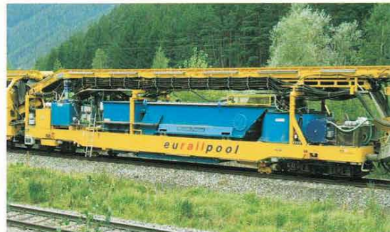
Kläranlage zur Wiederaufbereitung des Waschwassers
